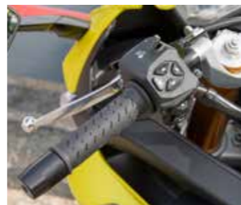
...waarin met behulp van de vier knoppen op de linker stuurhelft eenvoudig alle instellingen naar wens kunnen worden aangepast. De standaard aanwezige cruisecontrol wordt via een knop bovenop de linker stuurhelft bediend
