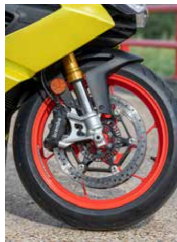
320mm schijven met 4-zuiger radiale remkluwen en 3 standen ABS, bochten-ABS is uit te schakelen
