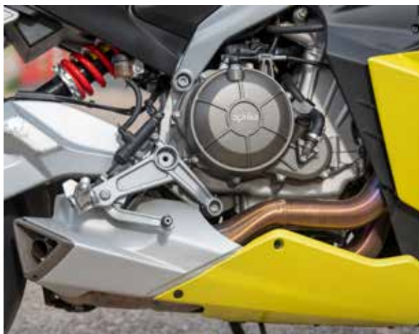
660cc tweecilinder motorblok met aan beide kanten een uitlaat die subtiel de lijn van de onderkuip volgt
