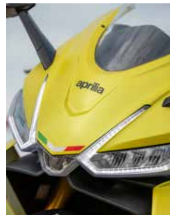
Led-koplampunit met richtingaanwijzers in de zijkanten van de dagrijlichtprofielen
